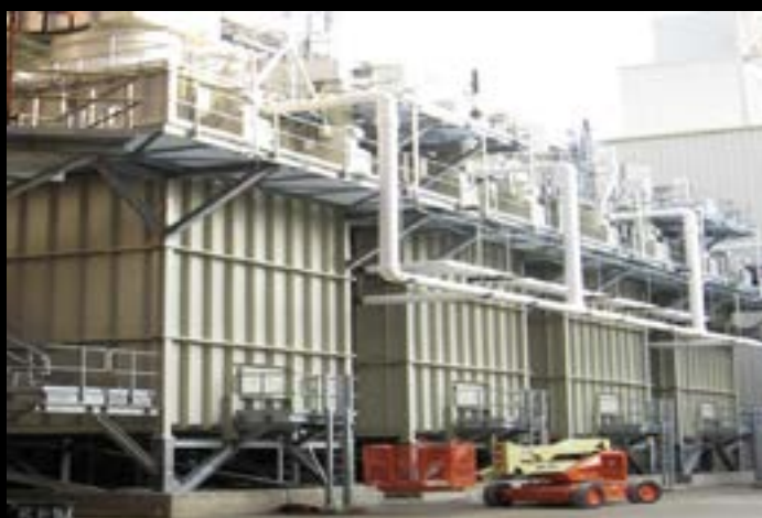
Electrofiltro Húmedo para Aplicación de Horno de Fibra de Vidrio para Aislamiento.
